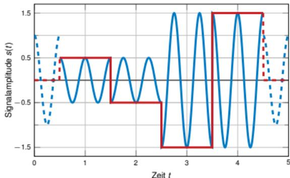
(b) Sendesignal  $s(t)$  (blau), Modulationssignal  $s_T(t)$  (rot)
