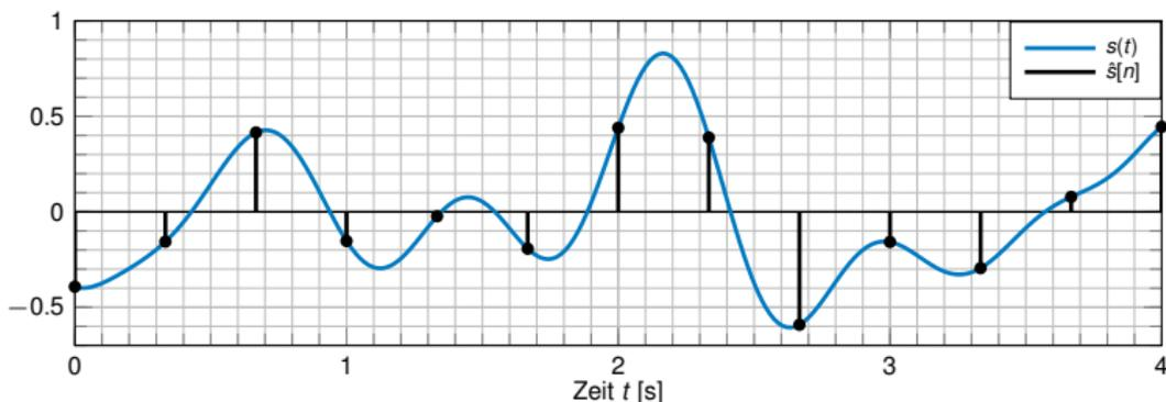
Abbildung 2: Zeitkontinuierliches Signal  $s(t)$  und Abtastwerte  $\hat{s}[n]$
